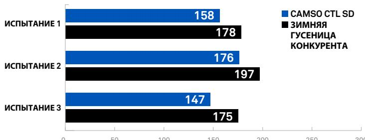
На протяжении всех испытаний гусеницы Camso демонстрировали **путь торможения на льду на 13% короче, чем у конкурента**, а также более высокую управляемость и меньший занос
